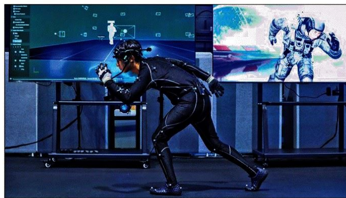
네이버의 가상 콘텐츠 제작 스튜디오 비전·모션스테이지에서 광학식 슈트를 착용한 직원이 3차원(3D) 애니메이션 구현을 시연하고 있다. 스튜디오에 설치된 적외선 카메라와 슈트에 장착된 전자 센서가 손가락 움직임과 얼굴 표정까지 정밀하게 포착해 캐릭터를 실시간으로 만들어낸다. 네이버 제공
