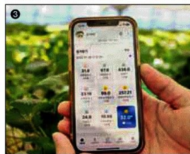
①김재혁 스트로팜 대표가 지난달 28일 강원 삼척의 스마트팜에서 여름 딸기를 살펴보고 있다. ②스마트팜 시스템 ‘팜스올’의 구성품인 센서. 온도와 습도, 일사량 등을 측정한다. ③팜스올이 수집한 농장의 기상 정보가 김 대표의 휴대전화 어플리케이션에 실시간 전송되고 있다.
