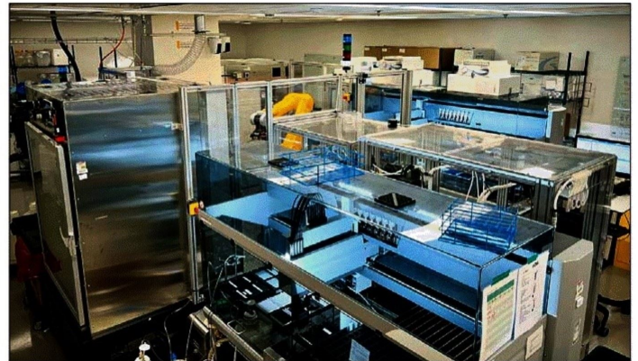
미국 머크 연구개발(R&D) 센터에 구축된 ‘랩터 시스템’ 연구실. 노란색 로봇팔이 360도를 돌며 알아서 단백질질을 만들고 배양·정제·포장 등 일련의 과정을 수행한다. 전 세계 제약사가 궁금해하는 이 시스템으로 10명이 하던 일을 2명에서 할 수 있게 됐다고 MSD는 설명했다. MSD
