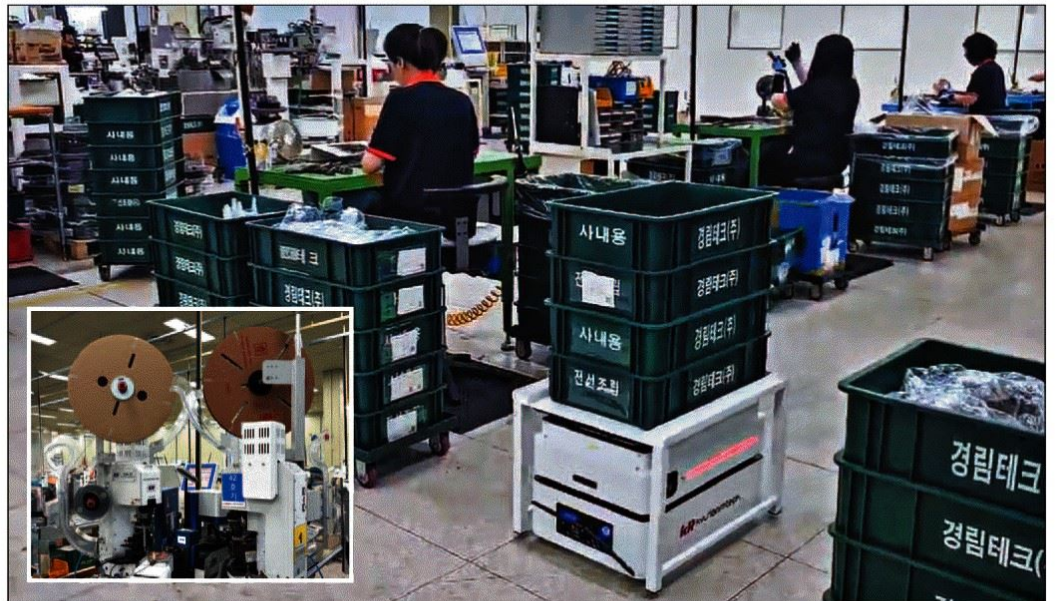
22일 경북 경산에 위치한 경림테크 공장에서 와이어링 하네스(전기 배선 묶음)를 적재한 물류 이송용 자율주행로봇이 작업자를 찾아 이동하고 있다. 작은 사진은 제품을 만들고 있는 자동절단기.
